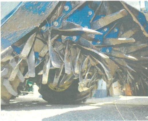
**Mehr Zinken:** Der hintere Rotor des Dyna Drive PRO hat doppelt soviele Zinken wie die bisherige. Die löffelartigen Werkzeuge sind um 4 cm verdreht.
