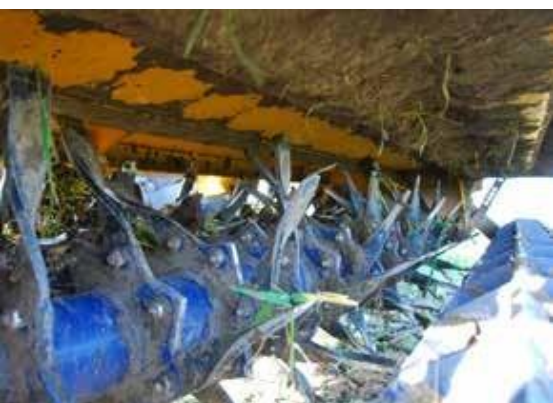
Die vordere Welle treibt die hintere mit dreifacher Geschwindigkeit an.
