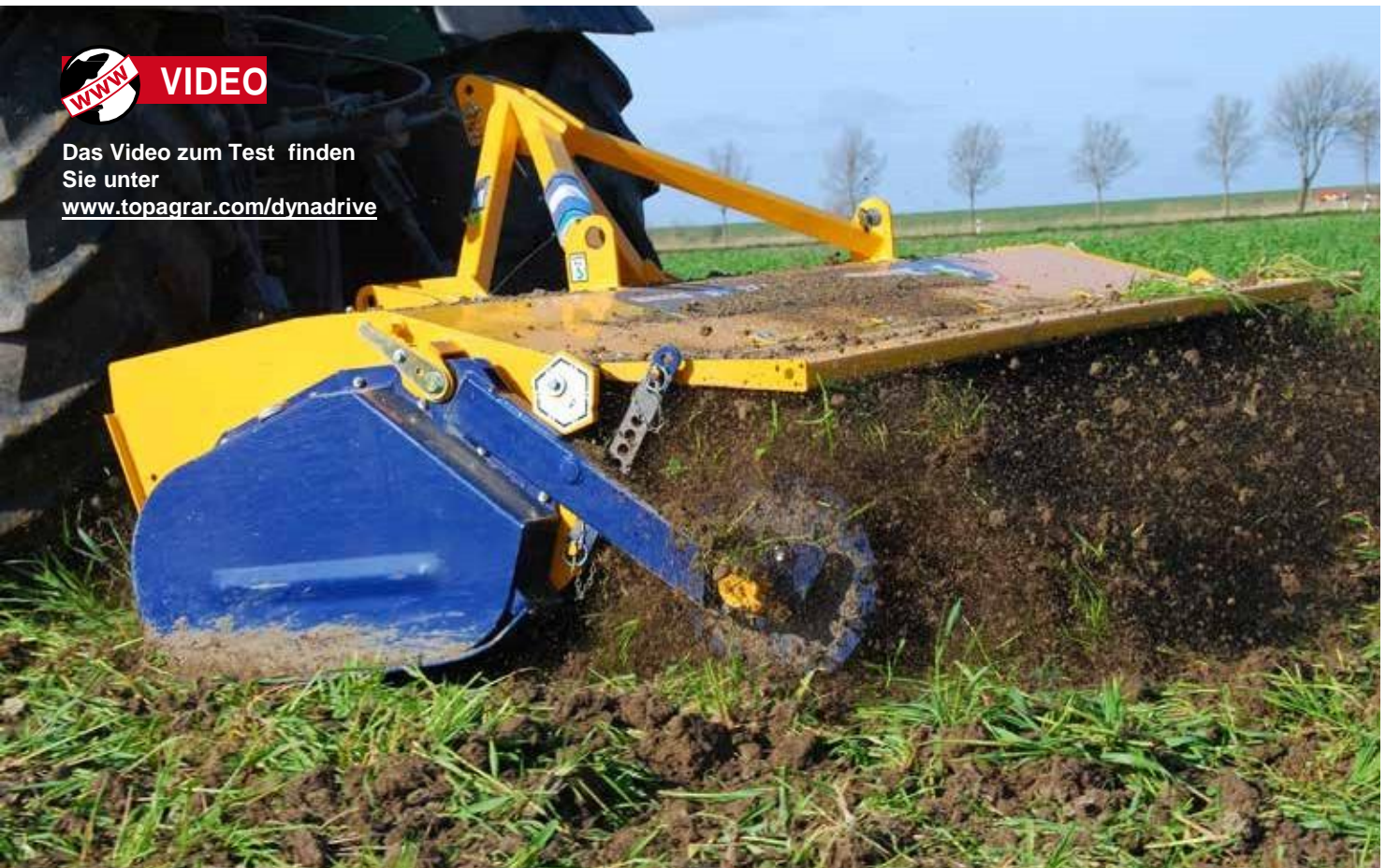
Der bodenangetriebene Dyna-Drive stammt aus England, in Deutschland läuft der Vertrieb über die Firma Rohn.
